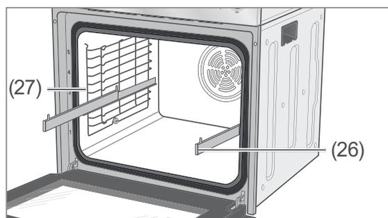
An den Seitenwänden des Garraums befinden sich die Backblechträger (27) mit den ausziehbaren Teleskopschienen (26). Damit lassen sich die Backbleche bequemer herausziehen, z. B. um einen Braten zu begießen.
