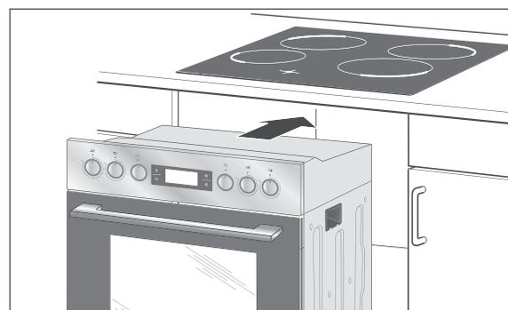
2. Heben Sie den Backofen an den seitlichen Tragemulden an, und schieben Sie ihn so weit in den Einbauschränk, dass die Anschlüsse und die Erdungsschraube für das Kochfeld noch gut zugänglich sind.
