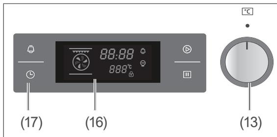
1. Tippen Sie auf den Sensor (L) (17). Die 0 für die Stundenzahl blinkt.
