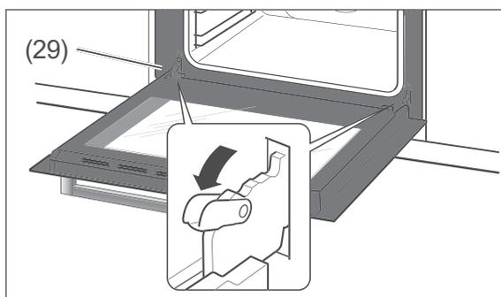
2. Klappen Sie an beiden Seiten die Bügel (29) ganz nach vorne. Nehmen Sie gegebenenfalls einen Schraubendreher zu Hilfe.
