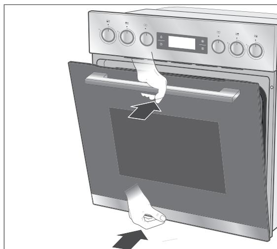
4. Heben Sie die Tür mit beiden Händen leicht an und lassen Sie sie nach vorne herausgleiten.
