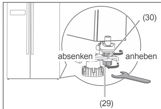
2. Drehen Sie die Sicherungsmutter (29) zwei volle Umdrehungen im Uhrzeigersinn, um sie zu lösen. Verwenden Sie dazu den mitgelieferten Schraubenschlüssel.
