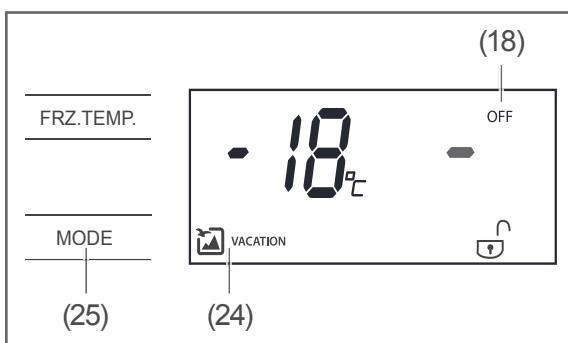
Sie können den Kühlbereich außer Betrieb nehmen (z. B. während des Urlaubs), ohne die Stromzufuhr zu unterbrechen. Der Gefrierbereich kühlt weiter.
