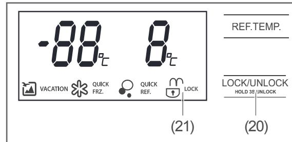
Die Kühl-Gefrier-Kombination ist gegen unbeabsichtigte Änderungen der Einstellungen gesichert. Das Symbol leuchtet in der Display-Anzeige. Wenn Sie eine beliebige Taste drücken, ertönt ein Signalton und die Anzeige (21) blinkt. Das Bedienfeld ist gesperrt.
