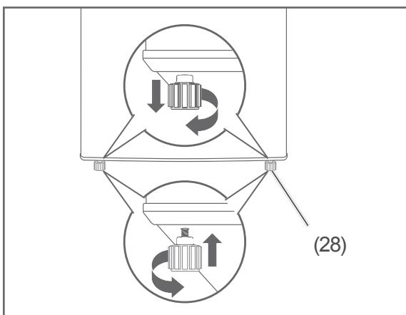
4. Gleichen Sie Unebenheiten des Untergrunds mithilfe der beiden vorderen Schraubfüße (28) aus.
