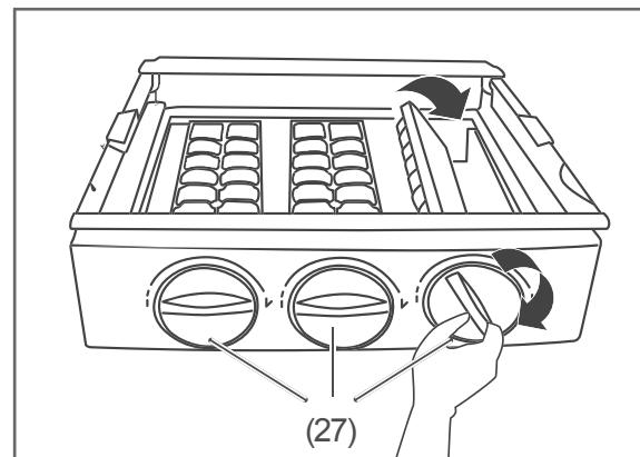
4. Um die Eiswürfel zu lösen, drehen Sie die Drehknöpfe (27) einen halben Kreis im Uhrzeigersinn.
