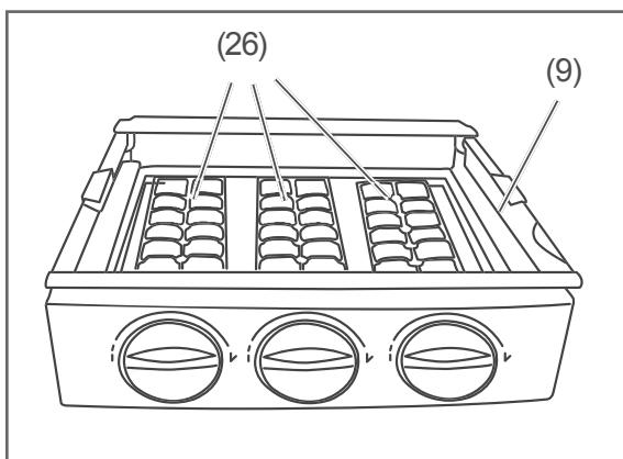
2. Füllen Sie die Eisschalen (26) bis zur Markierung WATER LEVEL mit frischem Trinkwasser.
