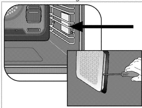
3. Lösen Sie das Schutzglas mit einem Schraubendreher.
