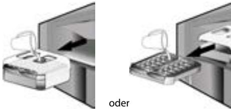
Setzen Sie den Ice Mate in das Gefrierfach zurück oder führen Sie die Eiswürfelschublade wieder in den Ice Mate ein. Verschütten Sie hierbei kein Wasser.
