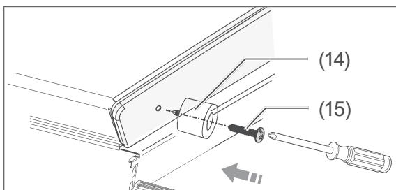
5. Schrauben Sie den beiliegenden Stützfuß (14) mittels der beiliegenden Schraube (15) an die Unterkante der Gerätetür.
