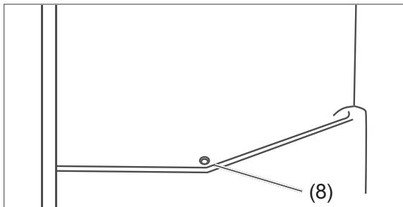
10. An der Rückwand des Kühlbereichs, oberhalb der Gemüseschublade befindet sich der Tauwasserabflusss (8). Reinigen Sie den Tauwasserabfluss (8) z. B. mit einem Zahnstocher.
