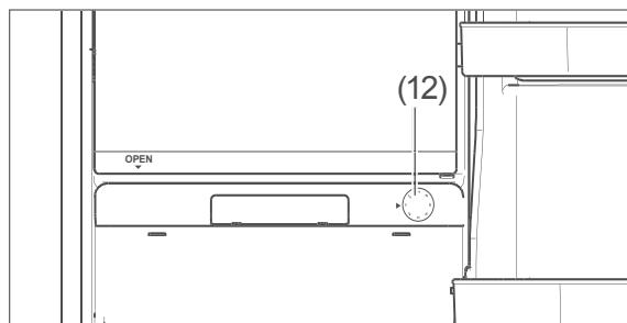
Der Temperatur-Regler (12) dient auch zum Ein- und Ausschalten des Geräts. Er befindet sich rechts unterhalb des Gefrierfachs und ist stufenlos einstellbar.
