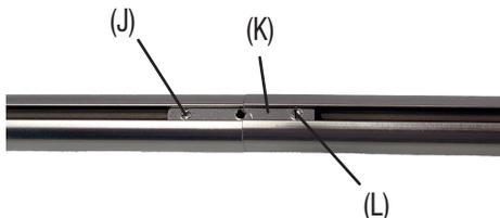
Möchten Sie einen Träger (siehe Schritt 3) genau bei der Profilstückelung setzen, kann der Nutstein (D) vom Träger (F) abgenommen werden (Nutstein wird nicht mehr benötigt). Befestigen Sie nun die Schraube (E), durch den Träger (F), am mittleren Loch des Profilverbinders (K).
