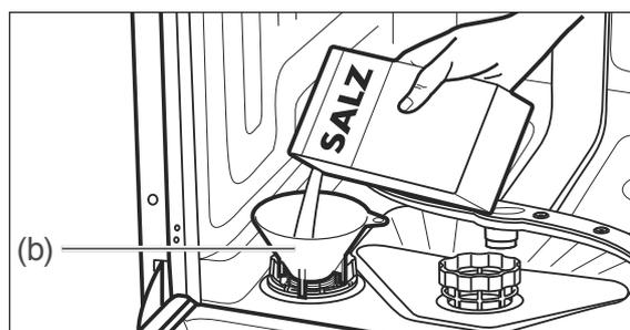
4. Setzen Sie den mitgelieferten Einfüll­ trichter (b) auf die Kammeröffnung.
