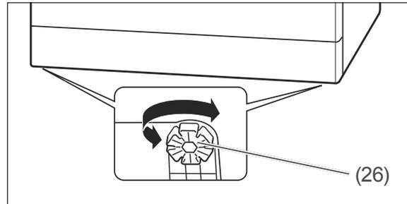
3. Um Unebenheiten des Bodens auszugleichen und den Geschirrspüler waagrecht auszurichten, können Sie die vier Gerätefüße (26) heraus- oder hineindrehen. In den Gerätefüßen sind ringsherum Schlitze angebracht. Stecken Sie hier einen Schraubendreher hinein und drehen Sie damit den Gerätefuß. Verwenden Sie zum Ausrichten des Geschirrspülers eine Wasserwaage.
