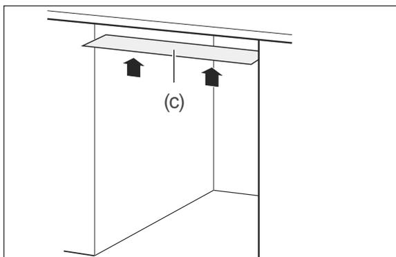
3. Kleben Sie die beiliegenden Schutzfolie für Kondenswasser (c) auf die Unterseite der Arbeitsplatte. So vermeiden Sie Schäden an der Arbeitsplatte aufgrund heißer Dämpfe, die bei geöffneter Tür aus dem Geschirrspüler strömen.
