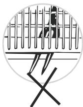
Beim Einladen des Bestecks darauf achten, dass das Besteck nicht durch den Boden des Besteckkorbs stößt. Der untere Sprüharm wird sonst blockiert.
