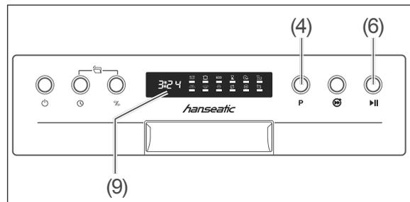
1. Drücken Sie die Taste ▶II (6), um das Spülprogramm zu unterbrechen. Die Restdaueranzeige (9) leuchtet dauerhaft.
