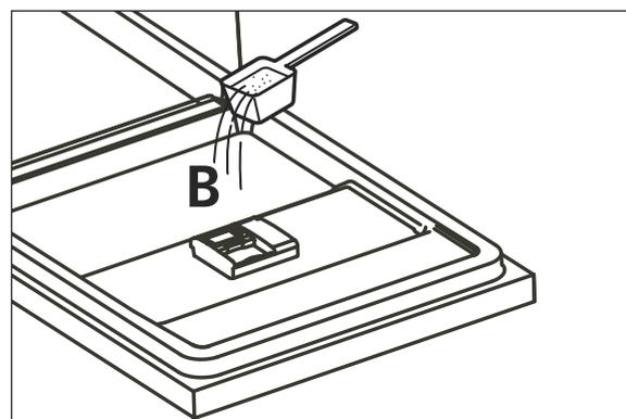
3. Geben Sie die restlichen 1/5 des Geschirrspülmittels auf die Innenseite der Tür. Diese Menge verwendet das Gerät während des Vorspülprogramms.
