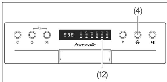
Mit dieser Option lässt sich das Reinigungsprogramm beschleunigen.
