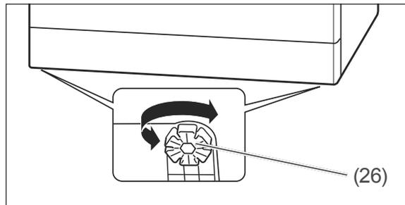
5. Um Unebenheiten des Bodens auszugleichen und den Geschirrspüler waagrecht auszurichten, können Sie die vier Gerätefüße (26) heraus- oder hineindreihen. In den Gerätefüßen sind ringsherum Schlitze angebracht. Stecken Sie hier einen Schraubendreher hinein und drehen Sie damit den Gerätefuß.
