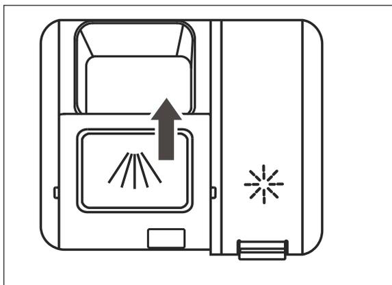
4. Drücken Sie den Deckel der Kammer zu, sodass der Verschluss (33) wieder einrastet.
