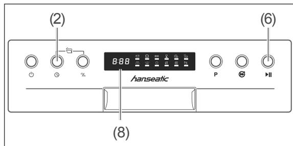
Der Spülvorgang beginnt normalerweise direkt nach dem Druck auf die Taste „Start/Pause“ **▶||** (6).
