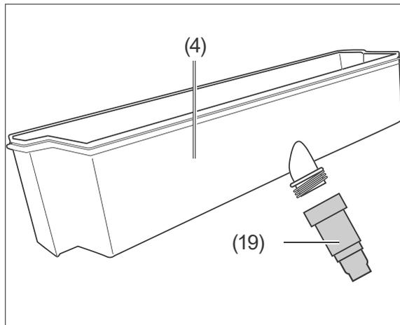
4. Schrauben Sie den Wasserauslass (19) vom Wassertank (4) ab.
