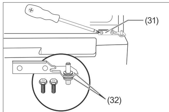
8. Schrauben Sie das mittlere Scharnier (31) ab, und nehmen Sie es heraus. Achten Sie dabei auf die Kunststoff-Scheiben (32). Diese müssen später wieder an der gleichen Position angebracht werden.
