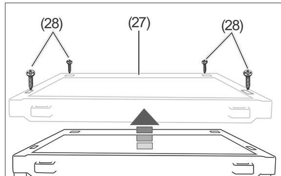
4. Lösen Sie mit einem Kreuzschlitzschraubendreher die Halteschrauben (28), und nehmen Sie den Gerätedeckel (27) ab.
