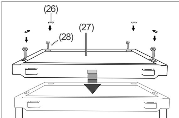
6. Schrauben Sie den Gerätedeckel (27) mit den Schrauben (28) wieder fest, und setzen Sie die Schutzabdeckungen (26) wieder ein.
