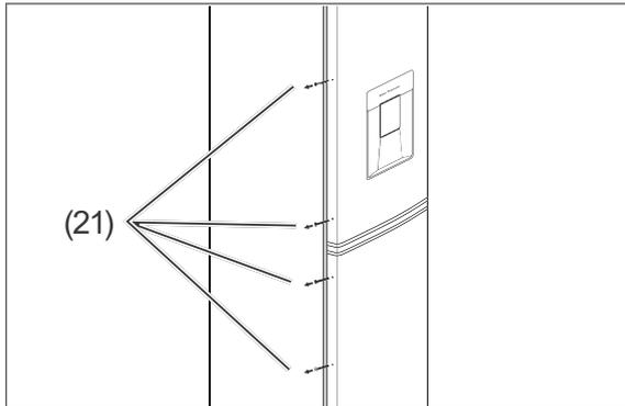
1. Lösen Sie mit einem Kreuzschlitzschraubendreher die Schrauben (21) an den Seiten der Türen.
