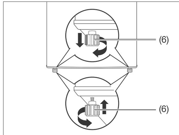
2. Gleichen Sie Unebenheiten im Untergrund mithilfe der beiden vorderen Schraubfüße (6) aus.
