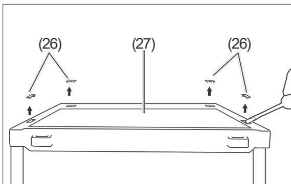
3. Hebeln Sie mithilfe eines Schlitzschraubendrehers die Schutzabdeckungen (26) am Gerätedeckel heraus.
