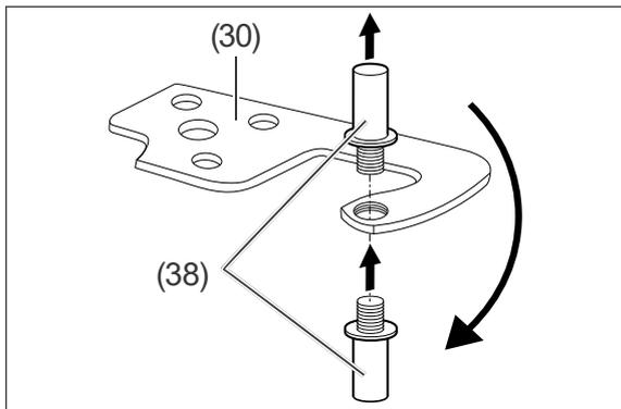
7. Schrauben Sie den Scharnierbolzen (38) des oberen Scharniers (30) mithilfe einer Zange heraus, und schrauben Sie ihn auf der anderen Seite der Scharnierplatte wieder hinein.
