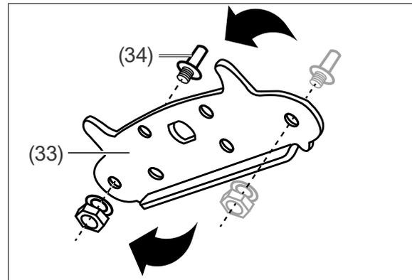
1. Versetzen Sie den Scharnierbolzen (34) des Scharniers (33) wie oben dargestellt.
