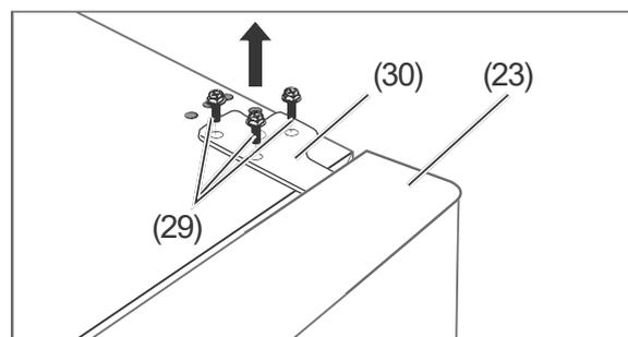
5. Schrauben Sie die 3 Schrauben (29) am oberen Scharnier (30) heraus.
