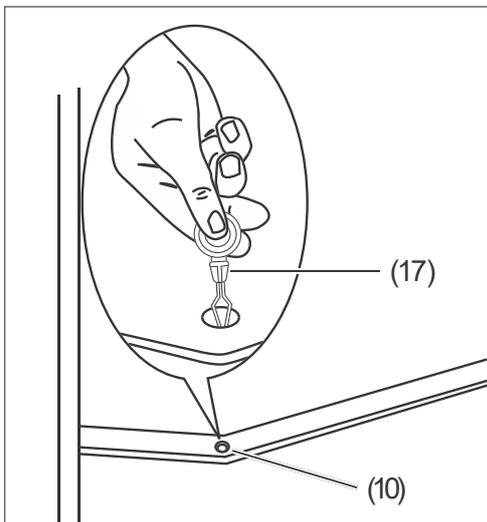
12. An der Rückwand des Kühlbereichs, oberhalb der Gemüseschublade befindet sich der Tauwasserablauf (10). Reinigen Sie ihn regelmäßig mit dem Reinigungswerkzeug (17).
