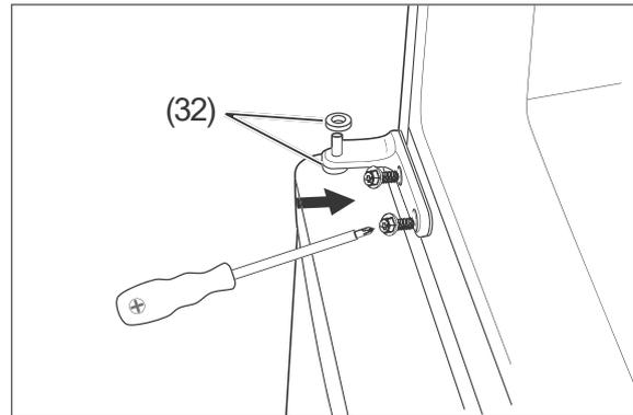
2. Setzen Sie das mittlere Scharnier (31) an der neuen Position wieder ein. Achten Sie dabei auf die Kunststoffscheiben (32). Schrauben Sie das mittlere Scharnier (31) fest.
