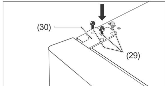
4. Setzen Sie das obere Scharnier (30) wieder ein und schrauben Sie es mit den Schrauben (29) fest.
