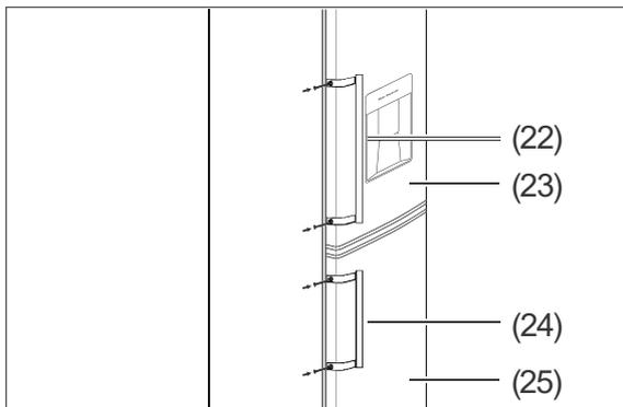
2. Befestigen Sie mit den Schrauben (21) den größeren Griff (22) an der Kühlbereichstür (23), den kleineren Griff (24) an der Gefrierbereichstür (25).
