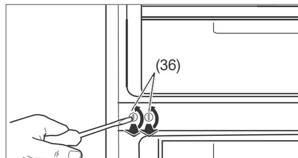
4. Drehen Sie mit einem Schlitzschraubendreher die beiden Blindstopfen (36) so, dass die Schlitz senkrecht stehen, und nehmen Sie die Blindstopfen ab.
