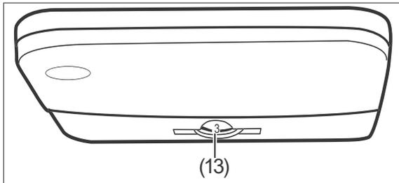
Der Temperatur-Regler (13) dient auch zum Ein- und Ausschalten des Geräts. Er befindet sich oben im Kühlbereich.
