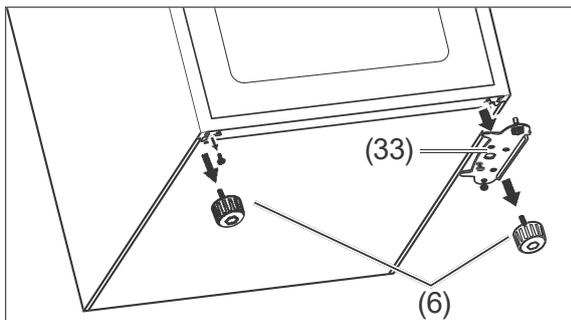
10. Kippen Sie das Gerät leicht nach hinten gegen eine Wand, sodass das untere Scharnier (33) zugänglich ist.
