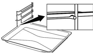
**Richtige Platzierung des Grillrosts und der Backbleche auf den Teleskopschienen - Bei Modellen mit Seitengittern und Teleskopschienen**
