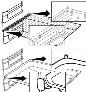
**Stopperfunktion für Backbleche - Bei Modellen mit Seitengittern**
