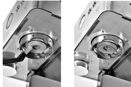
8. Hermonteer alle onderdelen en draai de schroef voorzichtig vast met een munt of een schroevendraaier.
