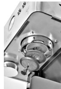
7. Nettoyez tous les éléments de la tête d'ébouillantage et le joint d'étanchéité avec le pinceau de nettoyage fourni (28). Si nécessaire, remplacez le joint avec le joint de remplacement fourni (24).
