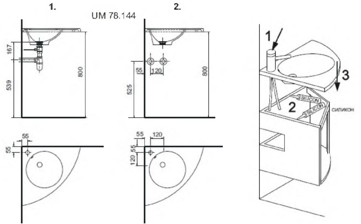
DE DER AUSFLUSS UM DARF SICH NICHT AN DER SELBEN WAND WIE DIE ECKVENTILE BEFINDEN.
