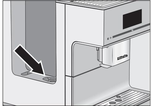
Das Wassertanksieb befindet sich unter dem Wassertank.
