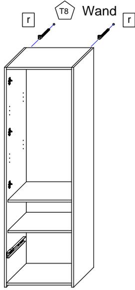
Lassen Sie den Schrank nur durch fachkundige Personen mit für die Wand geeignetem Montagematerialien montieren.
