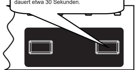
Schalten Sie das Gerät über die Ein-/Austaste ab, sobald die Abschlussleuchte aufleuchtet.
