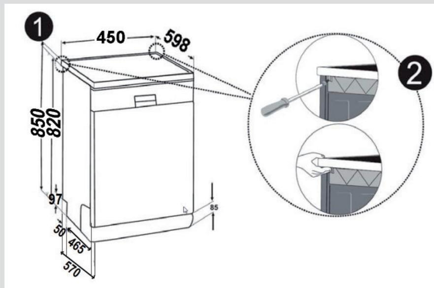
**Achtung:** Die Oberfläche, auf der Sie Ihre Spülmaschine nach Entfernung der Arbeitsplatte aufstellen möchten, muss so stabil sein, dass sie in der Waage steht.
