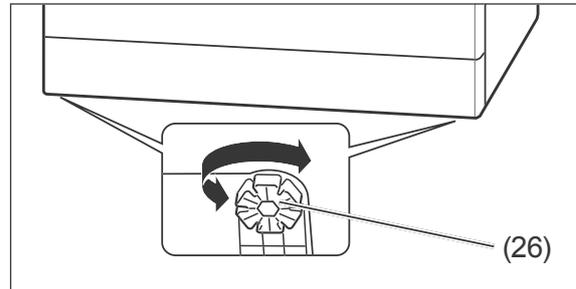
3. Um Unebenheiten des Bodens auszugleichen und den Geschirrspüler waagrecht auszurichten, können Sie die vier Gerätefüße (26) heraus- oder hineindreihen. In den Gerätefüßen sind ringsherum Schlitze angebracht. Stecken Sie hier einen Schraubendreher hinein und drehen Sie damit den Gerätefuß. Verwenden Sie zum Ausrichten des Geschirrspülers eine Wasserwaage.
