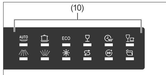
2. Drücken Sie die Programmwahltaste **P** (4) so oft, bis das gewünschte Programm in der Programmanzeige (10) aufleuchtet. Das Display (8) zeigt die Programmdauer an.
