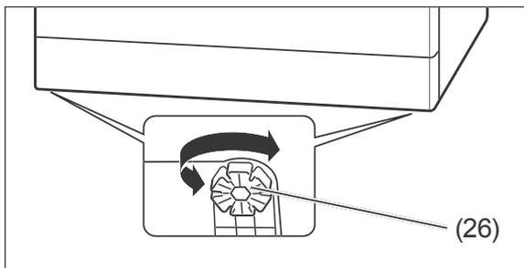
5. Um Unebenheiten des Bodens auszugleichen und den Geschirrspüler waagrecht auszurichten, können Sie die vier Gerätefüße (26) heraus- oder hineindrehen. In den Gerätefüßen sind ringsherum Schlitz angebracht. Stecken Sie hier einen Schraubendreher hinein und drehen Sie damit den Gerätefuß. Verwenden Sie zum Ausrichten des Geschirrspülers eine Wasserwaage.
