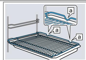
Rost Den Rost mit der offenen Seite zur Gerätetür und der Krümmung
