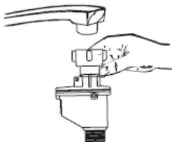
Verbinden Sie den Wasserzuleiterschlauch mit einem  $\frac{3}{4}$ " Gewindeanschluss und ziehen Sie das Ganze gut fest.
