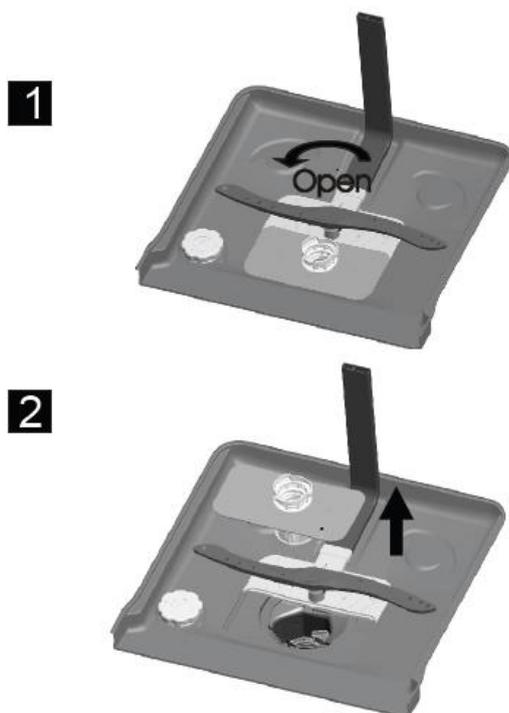
Schritt 2: Hauptfilter anheben
