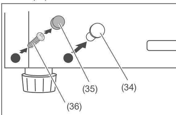
19. Hebeln Sie den Blindstopfen (34) und die Abdeckkappe (35) heraus, und lösen Sie die Schraube (36).
