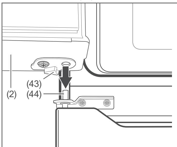
Setzen Sie die Kühlbereichstür (2) so wieder ein, dass der obere Teil des Stifts (44) in das Loch in der Metallverstärkung (43) gleitet.
