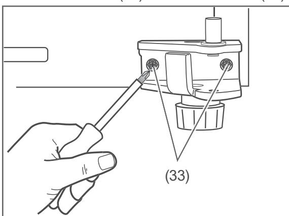
18. Lösen Sie die beiden Schrauben (33), und nehmen Sie das untere Scharnier (27) ab.
