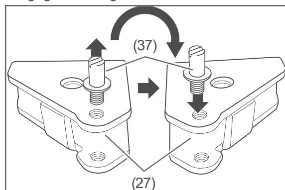
21. Drehen Sie die Stiftschraube (37) ab, drehen Sie das untere Scharnier (27) um und drehen Sie die Stiftschraube auf der anderen Seite wieder fest.
