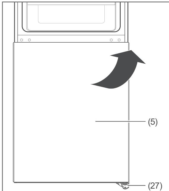
11. Heben Sie die Gefrierbereichstür (5) aus dem unteren Scharnier (27) und nehmen Sie sie ab.
