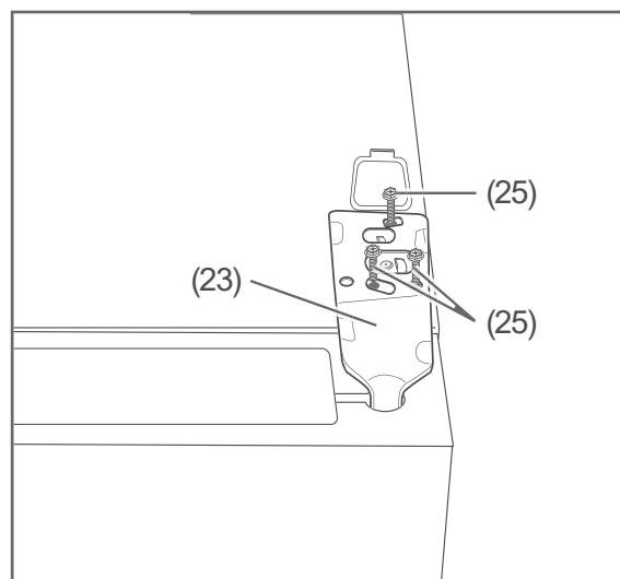
5. Lösen Sie die drei Schrauben (25) am oberen Scharnier (23), entnehmen Sie sie und bewahren Sie sie gut auf.
