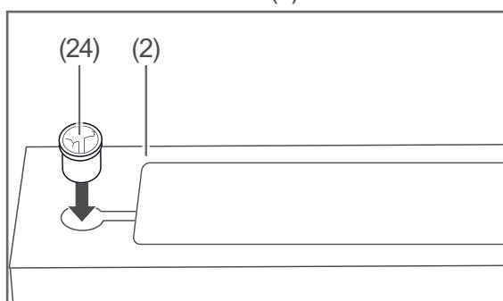
8. Setzen Sie den Kunststoff-Einsatz (24) auf der Oberseite der Kühlbereichstür (2) ein.
