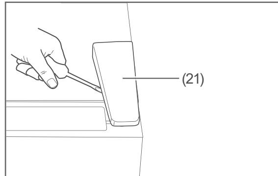
3. Hebeln die Blindplatte (21) an der oberen Tür vorsichtig mit einem Schlitz-Schraubendreher hoch, und heben Sie sie ab. Bewahren Sie die Blindplatte gut auf.
