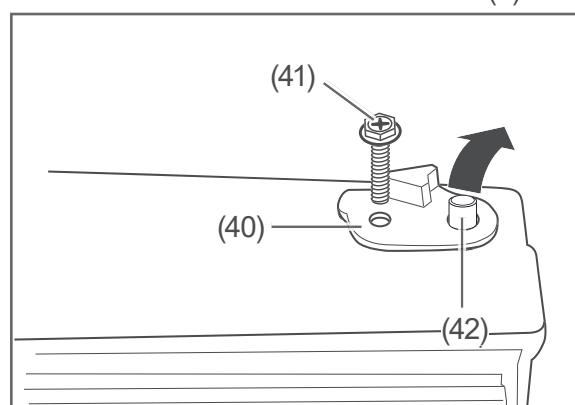
3. Lösen Sie die Schraube (41), und nehmen Sie die Metallverstärkung (40) und die Kunststoffhülse (42) ab.
