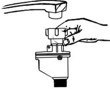
Das Gerät muss mit den neuen (beigelegten) Schläuchen angeschlossen werden. Verwenden Sie zum Anschluss des Geräts an die Wasserversorgung keine alten Schläuche. Der Wasserdruck sollte zwischen 0,04 MPa und 1 MPa betragen. Falls der Druck unter den Minimalwert liegt, wenden Sie sich an Ihr Wasserwerk.
