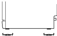
Richten Sie das Gerät mittels Verschrauben der verstellbaren Gerätefüße in die waagrechte Stellung aus. Das Gerät darf in keinem Fall um mehr als 2° geneigt sein.
