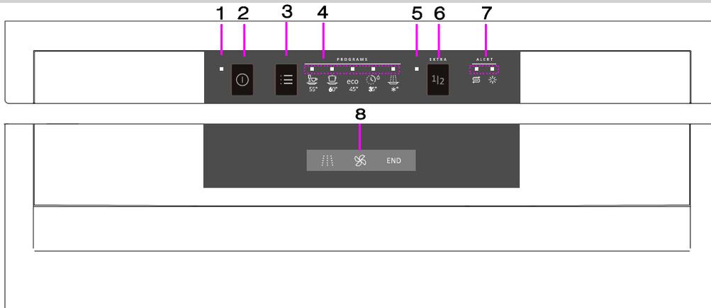
1. Betriebsanzeige: Zeigt an, dass das Gerät eingeschaltet ist.
