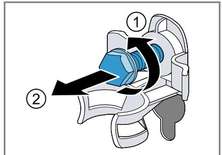
3. Die Netzanschlussleitung aus der Halterung ziehen.
