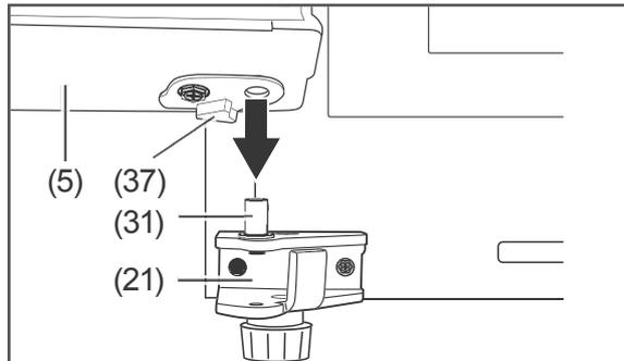
1. Setzen Sie die Gefrierbereichstür (5) so wieder ein, dass die Stiftschraube (31) am unteren Scharnier (21) in das Loch in der Metallverstärkung (37) gleitet.
