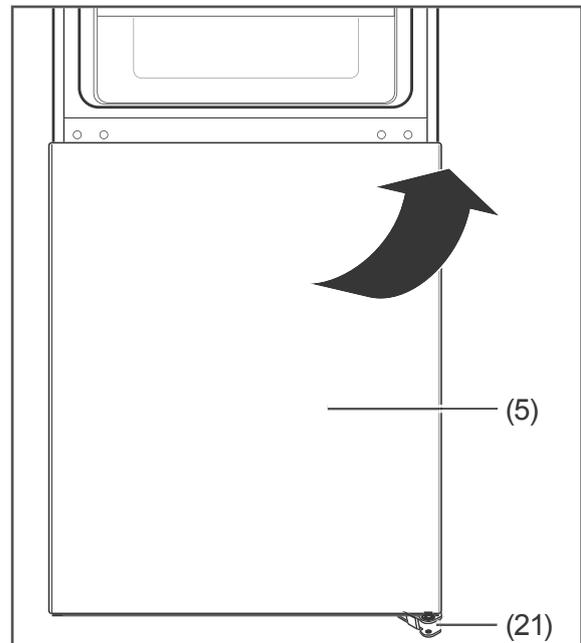
11. Heben Sie die Gefrierbereichstür (5) aus dem unteren Scharnier (21) und nehmen Sie sie ab.
