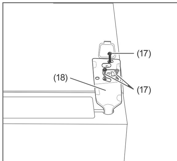
5. Lösen Sie die drei Schrauben (17) am oberen Scharnier (18), entnehmen Sie sie und bewahren Sie sie gut auf.
