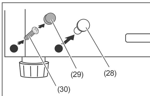
19. Hebeln Sie den Blindstopfen (28) und die Abdeckkappe (29) heraus, und lösen Sie die Schraube (30).
