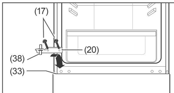
2. Bringen Sie das mittlere Scharnier (20) so wieder an, dass der untere Teil des Stifts (38) in den Einsatz (33) gleitet.
