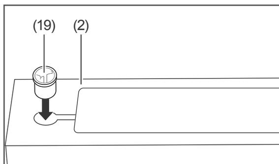
8. Setzen Sie den Kunststoff-Einsatz (19) auf der Oberseite der Kühlbereichstür (2) ein.
