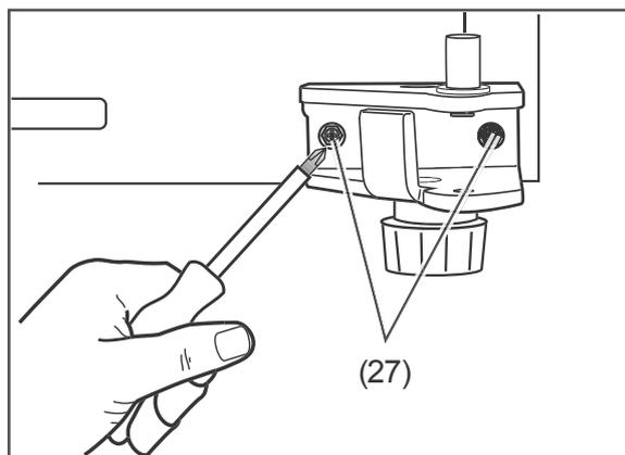
18. Lösen Sie die beiden Schrauben (27), und nehmen Sie das untere Scharnier (21) ab.
