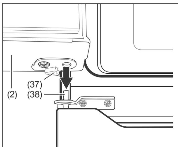
4. Setzen Sie die Kühlbereichstür (2) so wieder ein, dass der obere Teil des Stifts (38) in das Loch in der Metallverstärkung (37) gleitet.
