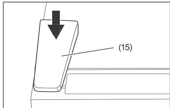
6. Setzen Sie die Blindplatte (15) auf der Anschlagseite wieder ein.
