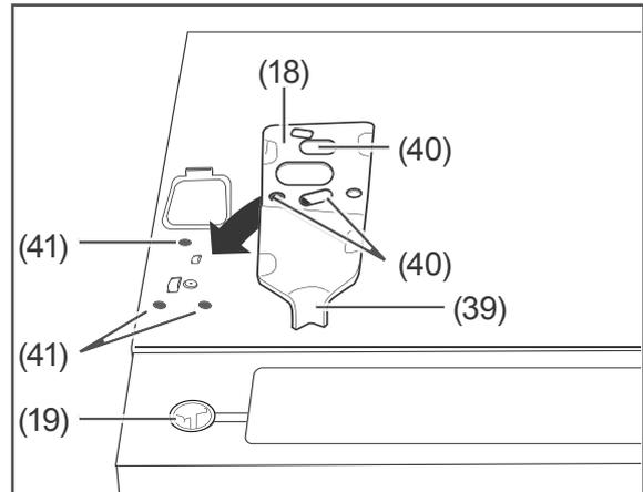
5. Setzen Sie das obere Scharnier (18) so ein, dass der Scharnierbolzen (39) in den Kunststoff-Einsatz (19) gleitet und die Schraubenlöcher (40) über den Bohrungen (41) in der Gerätedecke liegen.
