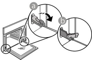
**1. Zur Entfernung der Tür,** diese vollständig öffnen und die Haken senken, bis sie sich in entriegelter Position befinden.
