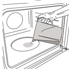
Wenn der Ofen kalt ist, die *Aussparung* mit der in der entsprechenden Gartabelle empfohlenen Menge an Trinkwasser füllen.
