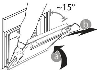
**2. Die Tür so weit wie möglich schließen.** Die Tür mit beiden Hände festhalten – diese nicht am Griff festhalten. Die Tür einfach entfernen, indem sie weiter geschlossen und gleichzeitig nach oben gezogen wird, bis
