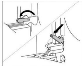
3. Schließen Sie langsam die Backofentür, bis die Laschen mit den Scharnieren an den Seitenlatten der Tür passen. Schließen Sie langsam die Tür im Winkel von 15° (im Bezug auf die geschlossene Position der Tür) und ziehen Sie sie von den beiden Scharnieren heraus.
