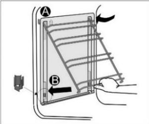
Platzieren Sie die Drahtführungen mit den katalytischen Einsätzen auf die oberen Öffnungen in den Seitenwänden des Garraums „B“. Drücken Sie sie in den Schnappverschluss an der Unterseite „B“.
