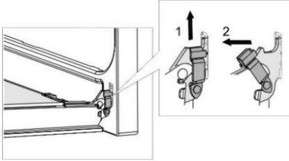
3. Schließen Sie langsam die Backofentür, heben Sie sie leicht an und ziehen Sie sie aus den beiden Scharnieren des Geräts heraus.
