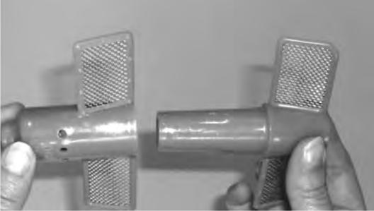
Schieben Sie den Schaumflügel A auf den unteren Schaumflügel B.
