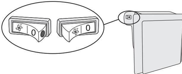
Wenn der Ventilator eingeschaltet ist, ist auf dem Schalter ein roter Punkt sichtbar.
