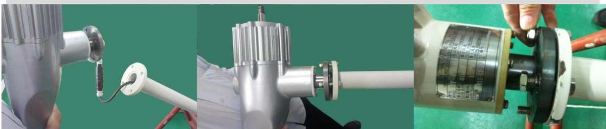
Schiebe das Kabel durch den Mast
