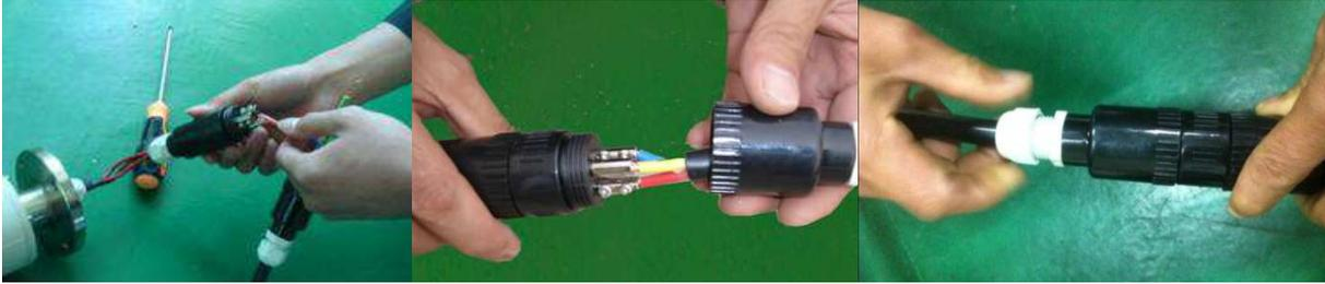
Schließe das 3-adrige Kabel vom Generator zum Lade-regler an der Klemme an.
