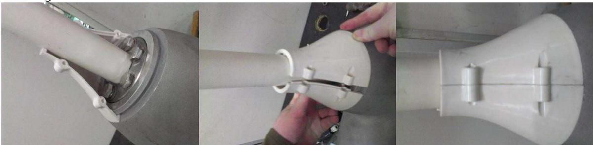
Schiebe die Abdeckungen auf den Verbindungsflansch
