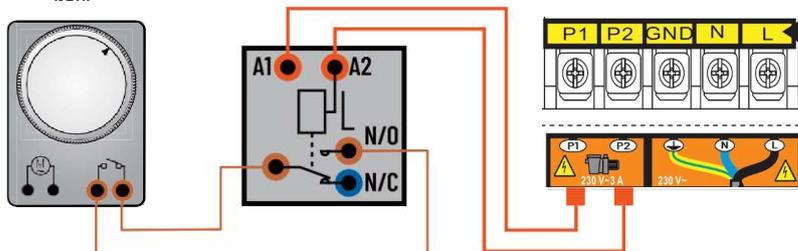
Parameter zur Berücksichtigung der Verbindung: Überprüfen Sie, ob die Einstellung des Filtrationspumpenparameters (Parameter #9) auf "2" gesetzt ist. Wenn dies nicht der Fall ist, kontaktieren Sie uns bitte, um die Einstellung zu ändern.
