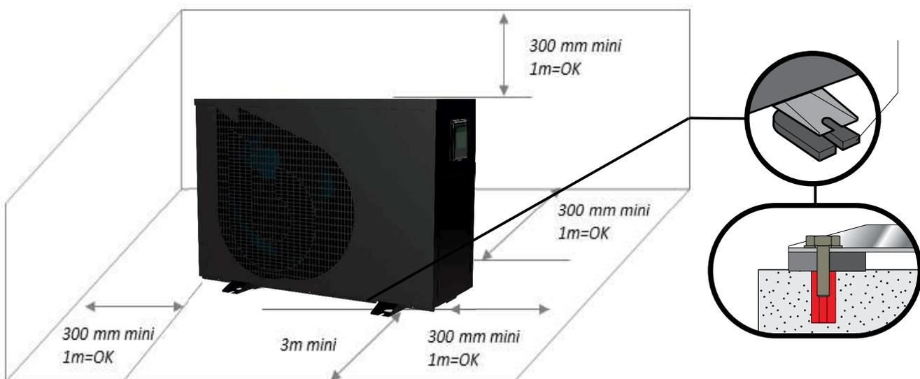
Die WP muss fix auf einem starren, festen Sockel installiert werden, wobei die mitgelieferten Bodenplatten unter den Füßen positioniert werden müssen.:
