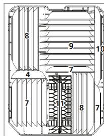
Der untere Korb ist aufgrund der besonders intensiven Reinigungswirkung des unteren Sprühdarms für das stark verschmutzte Geschirr geeignet. Räumen Sie z. B. Töpfe und Teller ein.
