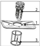
Das dreiteilige Filtersystem verhindert, dass größere Mengen an Speiseresten oder Fremdkörpern in das Spülsystem gelangen.
