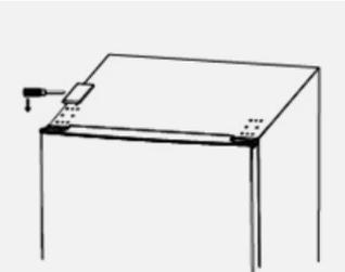
20. Den Stift des oberen Scharniers lösen und das Scharnier um 180° drehen.
