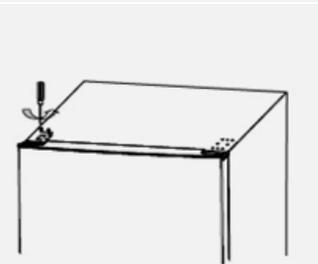
24. Bei Bedarf die Scharniere nachjustieren und die Abdeckkappe oben rechts aufstecken.
