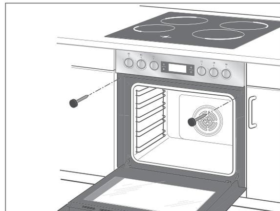
6. Schrauben Sie den Backofen mit den beiden mitgelieferten Schrauben am Einbauschrankschrank fest.
