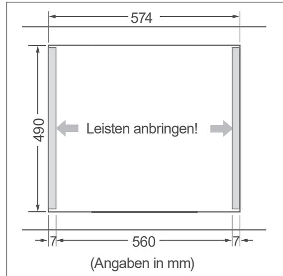
3. Bringen Sie links und rechts im Ausschnitt der Arbeitsplatte Ausgleichsleisten an, um eine Breite von 560 mm zu erreichen.
