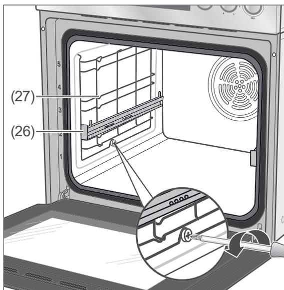
1. Lösen Sie die Schrauben am Backblechträger und nehmen Sie sie heraus.
