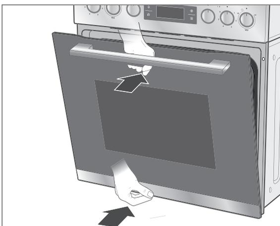
4. Heben Sie die Tür mit beiden Händen leicht an und lassen Sie sie nach vorne herausgleiten.
