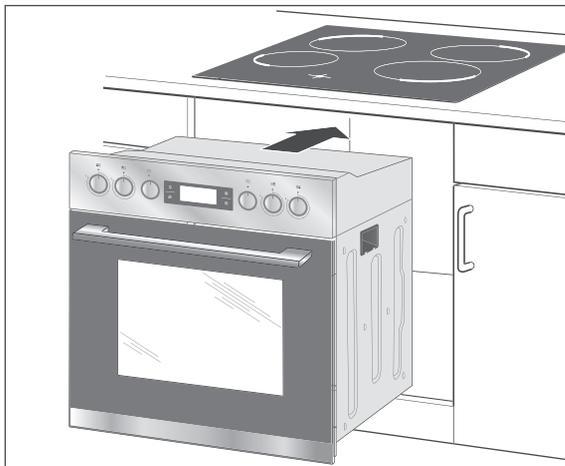
2. Heben Sie den Backofen an den seitlichen Tragemulden an, und schieben Sie ihn so weit in den Einbauschrankschrank, dass die Anschlüsse und die Erdungsschraube für das Kochfeld noch gut zugänglich sind.
