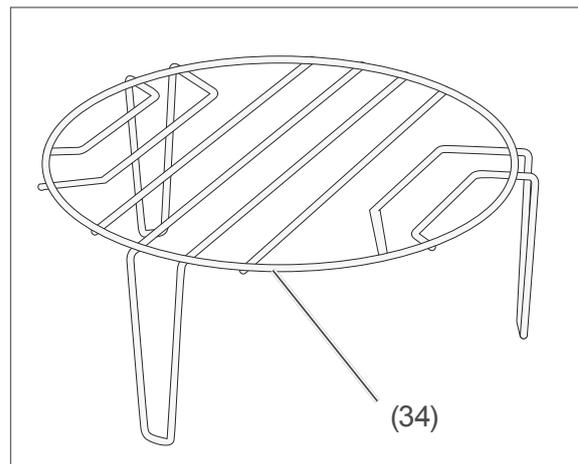
Der Grillrost (34) ist nicht für Mikrowellenbetrieb geeignet. Es kann sonst Funkenschlag entstehen. Verwenden Sie den Grillrost ausschließlich bei reinem Grillbetrieb oder bei Mikrowellen-Kombibetrieb [1] und [2].
