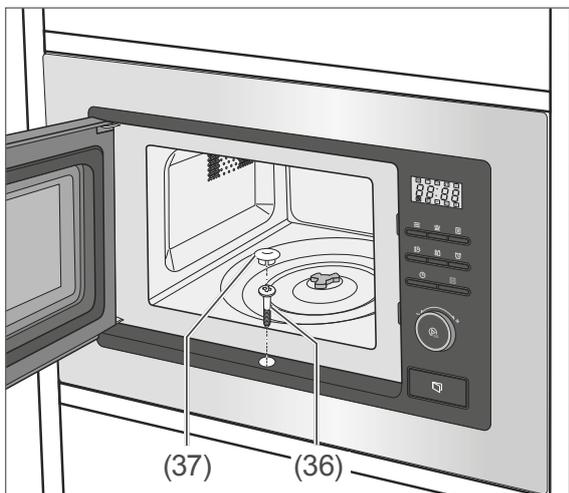
6. Sichern Sie das Gerät in der Bohrung mittels der mitgelieferten Schraube (36), und decken Sie die Schraube mit der Abdeckung (37) ab.
