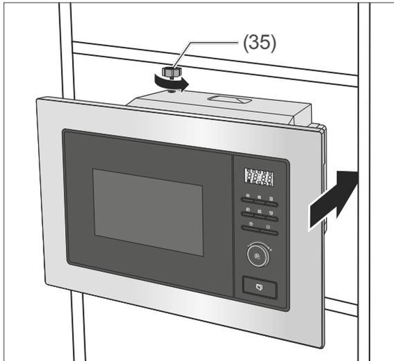
4. Stellen Sie die Fixierschraube so ein, dass ein Abstand von ca. 1 mm zwischen dem Einbaufach und der Fixierschraube besteht.
