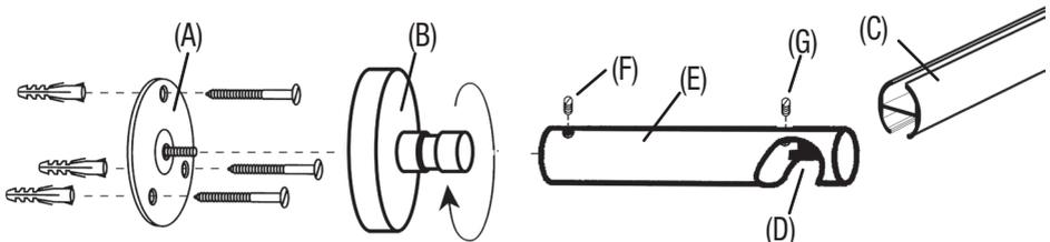
**Bitte beachten Sie VOR der Bohrung der Löcher in die Wand, dass bei Stückelungen (also an der Position der Profilverbinder) KEIN Träger gesetzt werden kann.**
