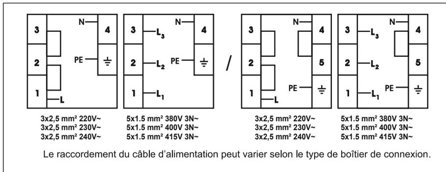
Le câble d'alimentation doit être correct et correctement isolé durant le branchement. Si le câble d'alimentation est endommagé, il doit être remplacé par le fabricant, son service Après-Vente ou une personne de qualification similaire afin d'éviter un danger.
