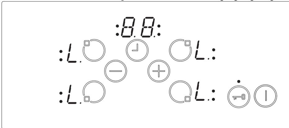
Falls der Erinnerungstimer laufen sollte, setzt er seinen Betrieb bis zum Ablauf der vorgegebenen Zeit fort, anschließend erklingt ein Signalton. *Nachdem Sie den Ablauf des Timers bestätigt haben*, ist das Gerät komplett gesperrt. Solange das Gerät gesperrt ist, können keine Tasten betätigt werden.
