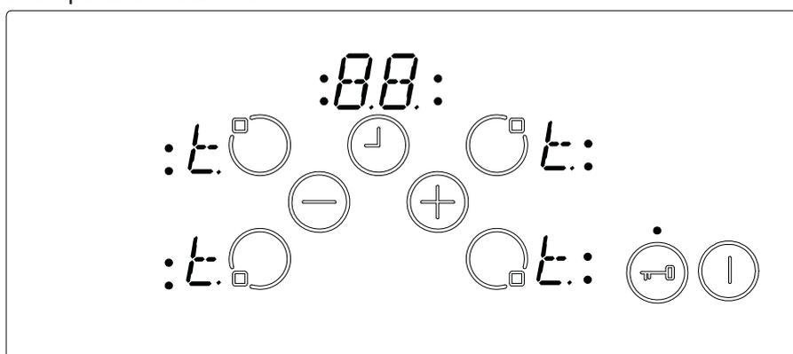
Après la baisse de température, la lettre T disparaît et l'unité de contrôle de la plaque passera au *Mode S*. Ceci signifie que l'utilisateur peut réactiver l'appareil en appuyant sur
