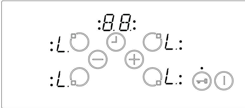
Si le rappel de minutes est encore en fonctionnement, celui-ci continuera jusqu'à ce qu'il atteigne «00» et la minuterie émettra un signal sonore. Après la confirmation de l'exécution de la minuterie, l'appareil sera complètement verrouillé. Aucune touche ne peut être utilisée tant que l'appareil est bloqué.
