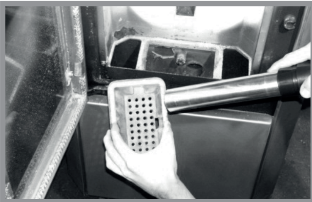
Abb. 12b: Reinigung der Luftöffnungen mit einem Staubsauger
