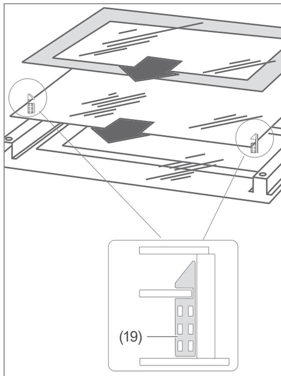
4. Nehmen Sie die obere Scheibe aus der Halterung unten am Scharnier heraus und legen Sie sie sicher ab.
