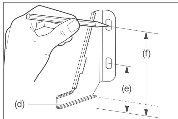
4. Halten Sie den Kippschutz (d) auf der Linie so an die Wand, dass die Seite mit den Löchern plan an der Wand aufliegt und der hervorstehende Schenkel in den Schlitz am Herd passt.
