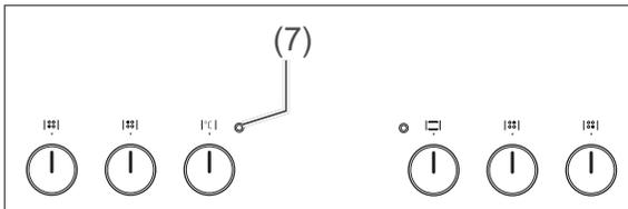
Die rote Backofen-Leuchte (7) leuchtet, sobald Sie eine Beheizungsart gewählt und die Temperatur eingestellt haben. Sie leuchtet, solange der Backofen auf- bzw. nachheizt. Wenn sie das erste Mal erlischt, ist die eingestellte Temperatur im Backofen erreicht.
