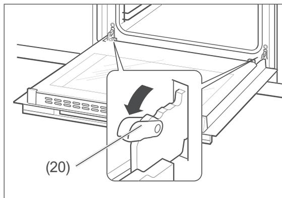
2. Klappen Sie an beiden Seiten die Bügel (20) ganz nach vorne. Nehmen Sie gegebenenfalls einen Schraubendreher zu Hilfe.
