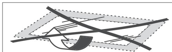
11. Setzen Sie die obere Scheibe wieder in die Halterung im Scharnierbereich. Achten Sie darauf, dass die glatte Seite außen ist.
