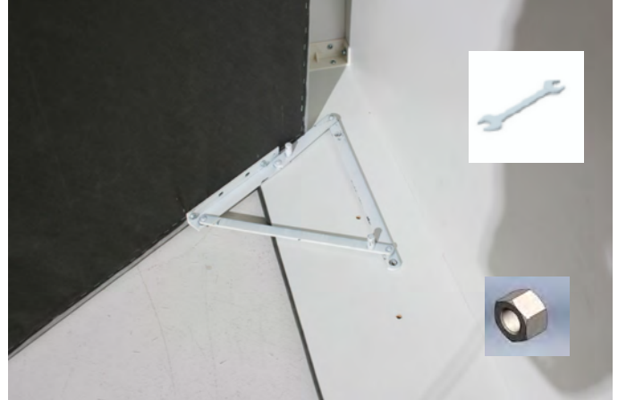
b) Liegefläche mit den Muttern am Beschlag festschrauben
