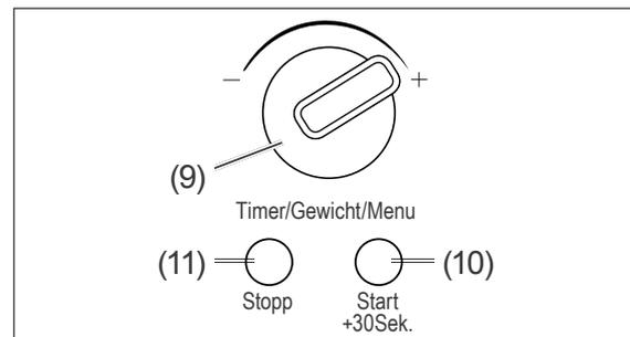
3. Drehen Sie den Drehknopf (9) so lange, bis im Display die gewünschte Dauer des Auftauvorgangs erscheint (mögliche Eingaben: 5 Sekunden – 95 Minuten).
