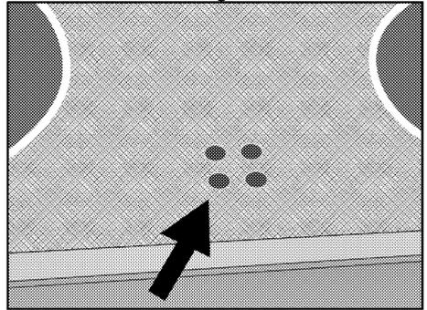
Die Warnanzeige für die heiße Zone zeigt die Position des eingeschalteten Kochfelds an und leuchtet nach dem Ausschalten weiter. Ein flackerndes Licht auf der Warnanzeige für die heiße Zone ist keine Fehlfunktion.
