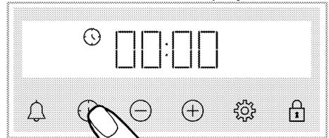
**i** Nach der Einstellung der Betriebsfunktion und der Temperatur können Sie durch direktes Berühren der Taste  $\oplus$  die Garzeit für 30 Minuten einstellen und mit den Tasten  $\oplus/\ominus$  die Zeit ändern.
