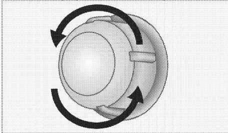
3. Wenn Ihre Ofenbeleuchtung dem Typ A in der nachstehenden Abbildung entspricht, drehen Sie das Leuchtmittel wie in der Abbildung gezeigt heraus, setzen Sie dann ein neues Leuchtmittel ein. Wenn Ihr Gerät Typ B verwendet, ziehen Sie das Leuchtmittel wie in der Abbildung gezeigt heraus, danach setzen Sie das neue Leuchtmittel ein.
