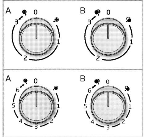
Ihr Gerät ist möglicherweise mit Zonen vom Typ A oder B ausgestattet. Mehrere Kochzonen ermöglichen das Kochen mit Töpfen mit unterschiedlichen Durchmessern in derselben Zone. Wenn diese Zonen zum ersten Mal eingeschaltet werden, wird die Zone in der Mitte eingeschaltet. (Der schattierte Bereich in der Abbildung sind zentrale Zonen.)
