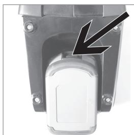
1. Het apparaat uitschakelen en de accu (7) als volgt eruit halen: de ontgrendelingsknop op de accu (zie afbeelding) indrukken en de accu gelijktijdig uit het apparaat trekken.
