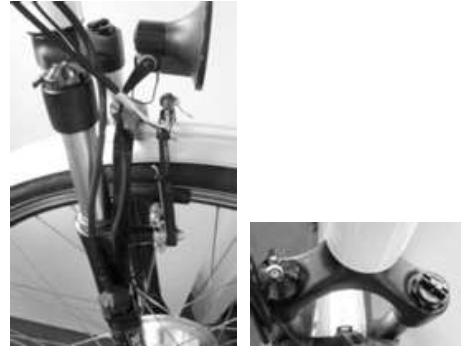
Einstellbare Federgabel mit Lock-Out (Sperrung) und Justiermöglichkeit
