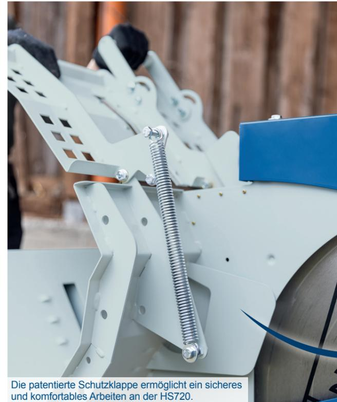
Die patentierte Schutzklappe ermöglicht ein sicheres und komfortables Arbeiten an der HS720.
