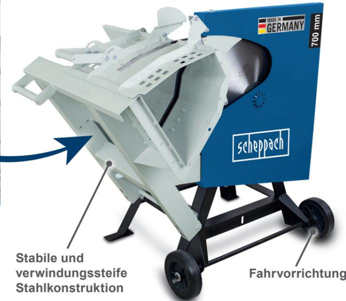
Stabile und verwindungssteife Stahlkonstruktion
