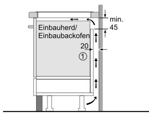
① Lüftungsspalt muß vorgesehen werden. min. 550 Maße in mm
