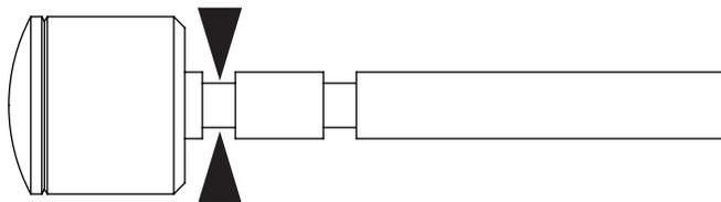
Vollständig herausgezogen (in hintere Nut der Regulierungsstange eingerastet) = geschlossen
