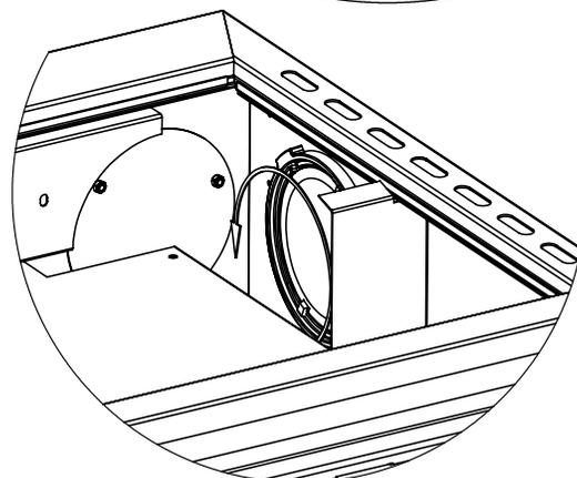
Seitenverkleidung wieder montieren. An der Unterkante der Seitenverkleidung sind zwei Zapfen angebracht.
