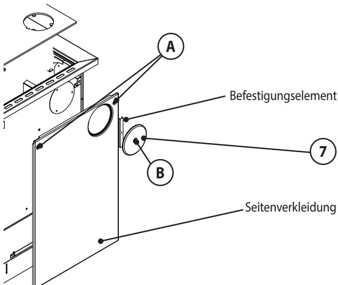
Verschlussdeckel (7) und Befestigungselement werden nicht mehr benötigt!
