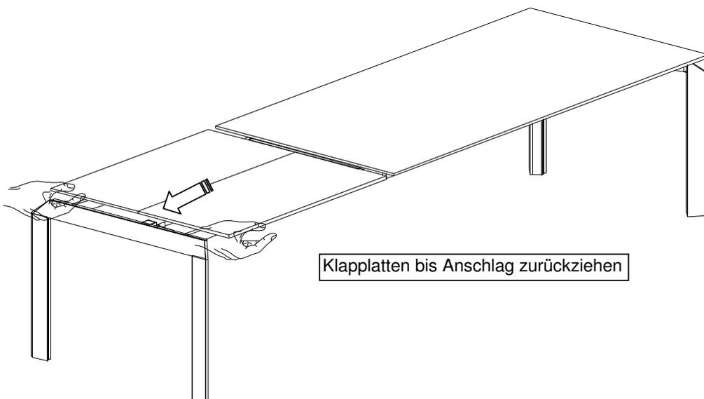
Klapplatten bis Anschlag zurückziehen
