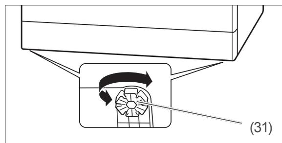
3. Um Unebenheiten des Bodens auszugleichen und das Gerät waagrecht auszurichten, können Sie die vier Stellfüße (31) heraus- oder hineindrehen. Die Stellfüße haben ringsherum Schlitze. Stecken Sie hier einen Schraubendreher hinein und drehen Sie damit den Stellfuß. Verwenden Sie zum Ausrichten des Geräts eine Wasserwaage.
