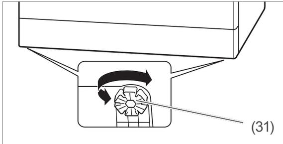
5. Um Unebenheiten des Bodens auszugleichen und das Gerät waagrecht auszurichten, können Sie die vier Stellfüße (31) heraus- oder hineindrehen. Die Stellfüße haben ringförmig Schlitze. Stecken Sie hier einen Schraubendreher hinein und drehen Sie damit den Stellfuß. Verwenden Sie zum Ausrichten des Geräts eine Wasserwaage.
