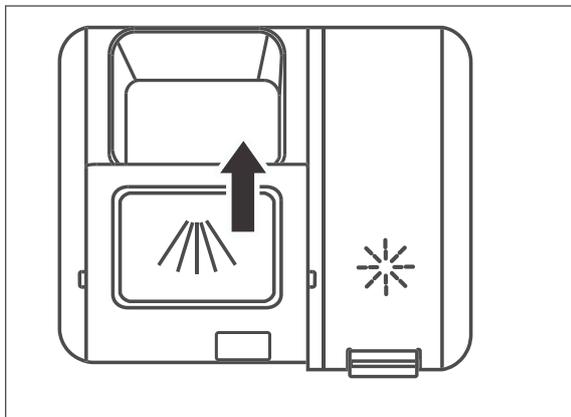
4. Schieben Sie den Deckel der Kammer zu, sodass der Verschluss (33) wieder einrastet.
