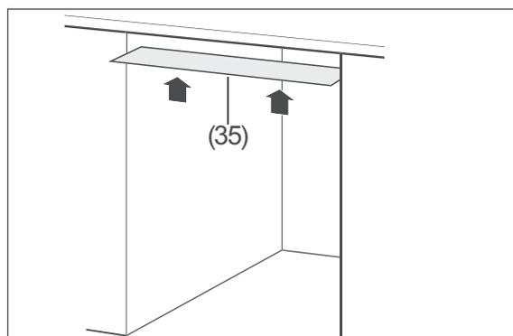
3. Kleben Sie die beiliegenden Schutzfolie für Kondenswasser (35) auf die Unterseite der Arbeitsplatte. So vermeiden Sie Schäden an der Arbeitsplatte aufgrund heißer Dämpfe, die bei geöffneter Gerätetür aus dem Gerät strömen.
