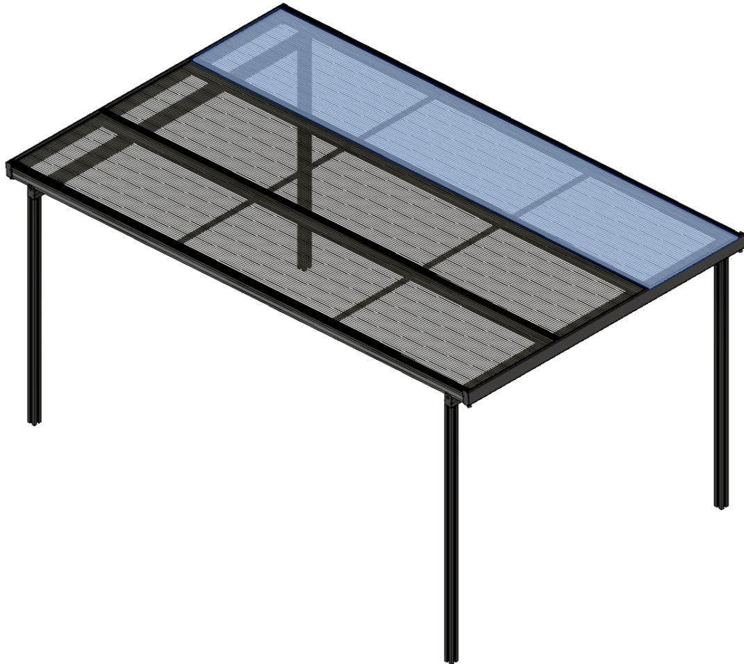
Montieren Sie in der gleichen Art und Weise die 3. Platte und verschrauben Sie diesen Deckel wie im Schritt 14. Ziehen Sie anschließend die Schutzfolien ab.
