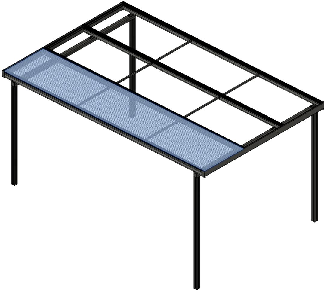
Legen Sie die erste Platte auf und richten Sie sie korrekt aus – beachten Sie auch hier die korrekte Ausrichtung der Schutzfolien. Profiloberteil alle 40 cm mittig vorbohren ( $\varnothing 7$  mm), die erste Bohrung erfolgt nach 6cm. Anschließend auflegen und mit dem Unterteil verschrauben.
