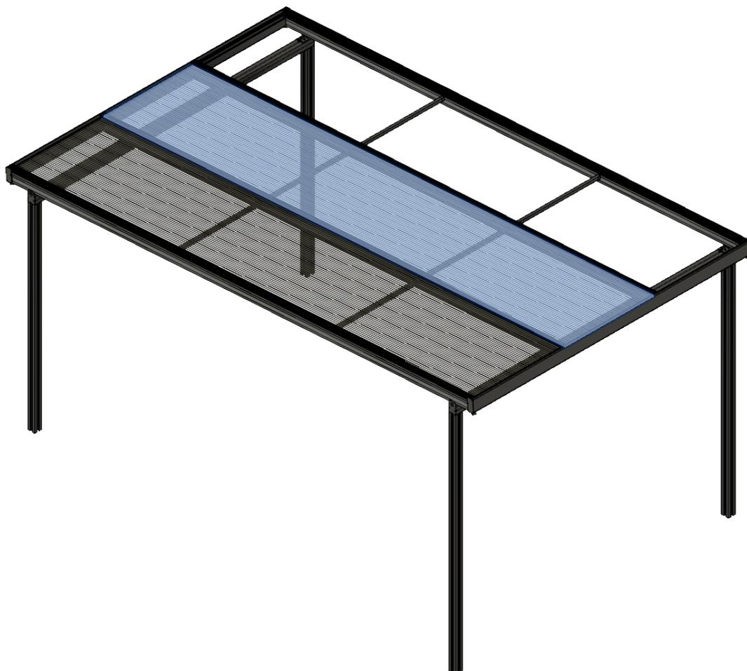
Montieren Sie in der gleichen Art und Weise die 2. Platte und verschrauben Sie diesen Deckel wie im Schritt 14. Ziehen Sie anschließend die Schutzfolien ab.
