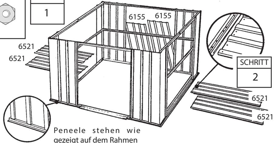
2 Stellen Sie sicher, daß Sie für jede Position das richtige Paneel haben. Das tun Sie, indem Sie die Paneele überlappen und feststellen, ob die Bohrungen sich mit den Bohrungen im Rahmen decken.
