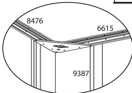
**3** Die seitlichen Dachrahmen mit selbstschn. Schrauben oben entlang der Seitenpaneele befestigen. Die seitlichen Dachrahmen müssen in den Ecken den hinteren Dachrahmen überlappen.
