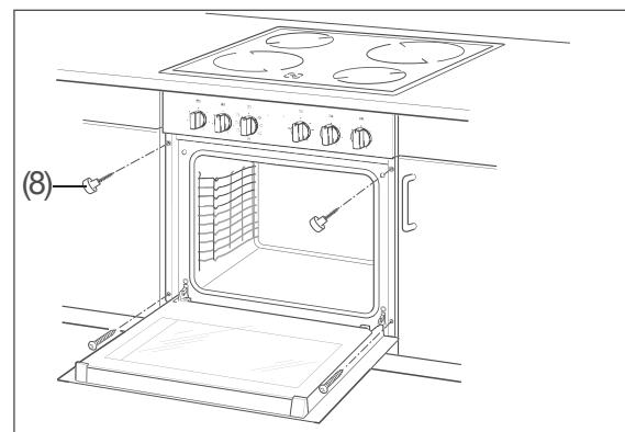
5. Schrauben Sie die beiliegenden Schrauben (8) durch die Löcher an den Seiten des Backofens in die Seiten des Unterbauschrankes.
