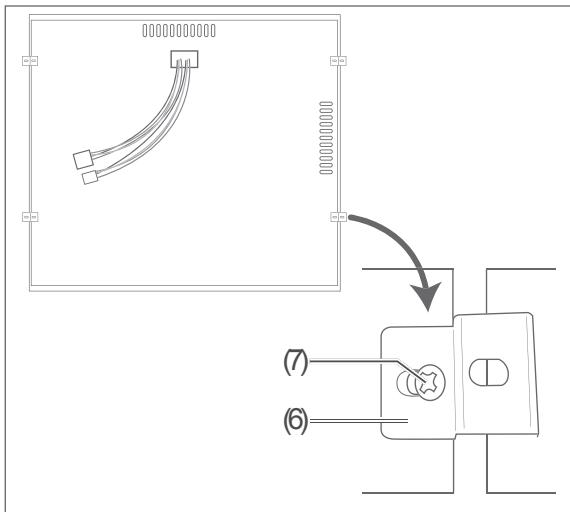
4. Um ein Rutschen des Kochfelds zu verhindern, muss es mit den beiliegenden Klammern (6) und Schrauben (7) an der Arbeitsplatte fixiert werden.
