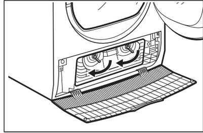
4. Klappen Sie den Kondensatordeckel nach unten.
