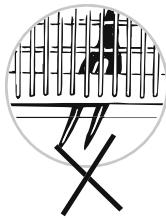
Beim Einladen des Bestecks darauf achten, dass das Besteck nicht durch den Boden des Besteckkorbs stößt. Der Sprüharm wird sonst blockiert.
