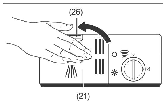
4. Drücken Sie den Deckel der der Spülmittelkammer (21) zu, sodass der Verschluss (26) wieder einrastet.
