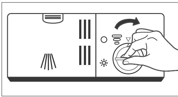
4. Setzen Sie den Verschluss der Klarspülkammer (22) ein und drehen Sie ihn eine Viertelumdrehung im Uhrzeigersinn fest. Die Markierungen am Deckel und der Klarspülkammer (22) müssen beim Einsetzen fluchten.
