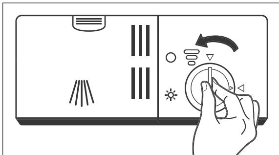
1. Drehen Sie den Verschluss der Klarspülkammer (22) eine Viertelumdrehung gegen den Uhrzeigersinn und nehmen Sie ihn heraus.
