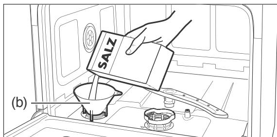
4. Setzen Sie den mitgelieferten Einfülltrichter (b) auf die Kammeröffnung.
