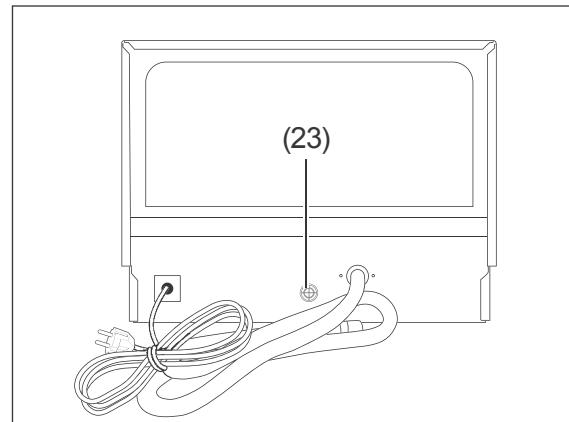
1. Schrauben Sie die Überwurfmutter des Zulaufschlauchs am Anschluss (23) des Geräts fest.
