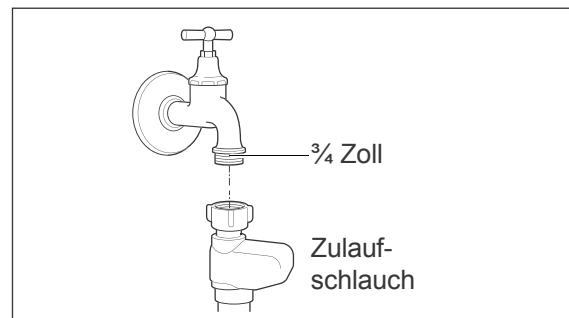
2. Ziehen Sie die Überwurfmutter mit Aquastop des Zulaufschlauchs handfest an den Wasserhahn an.
